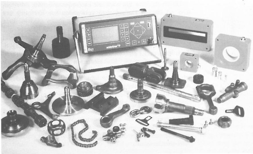
Bild 6. eddyliner®P Mehrfrequenz-Wirbelstromprüfgerät Fig. 6 eddyliner®P multi-frequency eddy current test instrument
